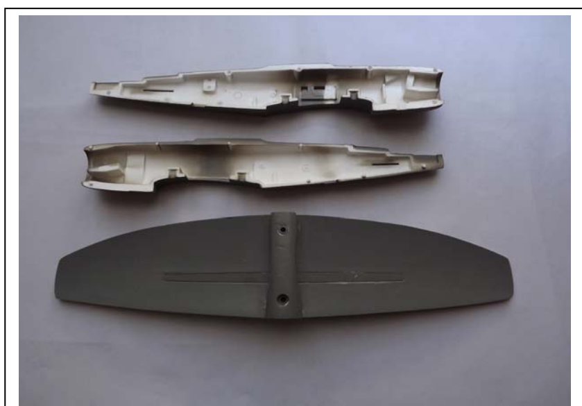
FIG. 1 : Ali e fusoliera come da scatola di montaggio. Fusoliera 18 gr. Ali con raccordo centrale e baionette 22gr.
