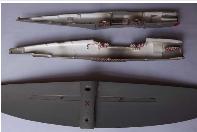
FIG. 2 : Parti da eliminare segnate in rosso Pesì iniziali:Fusoliera 18 gr. Ali 22 gr.
