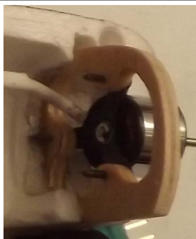
FIG.7 : Ordinata motore da incollare sulla fiancata sinistra
